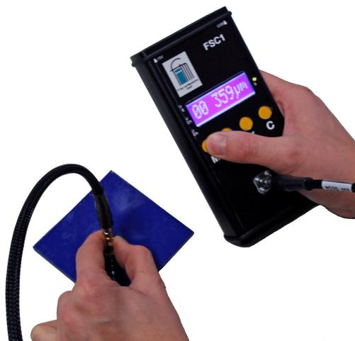
Bild 5: Lackdickenmessgerät bestehend aus direkt anzeigendem Handgerät und über Kabel verbundene Sonde.
