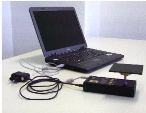
Bild 1: Prototyp des Messsystems, bestehend aus Handgerät mit aufgelegter plattenförmiger Probe und Laptop zur Auswertung
