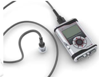
SONOWALL 50 mit integriertem Datenlogger
