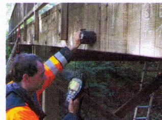
Abb.7 Prüfung mit Ultraschallecho
