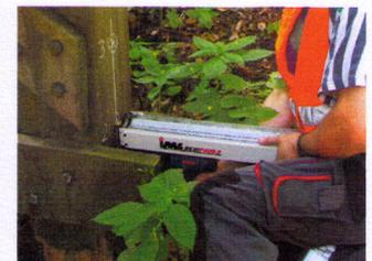
Abb.8 Prüfung mit Bohrwiderstand
