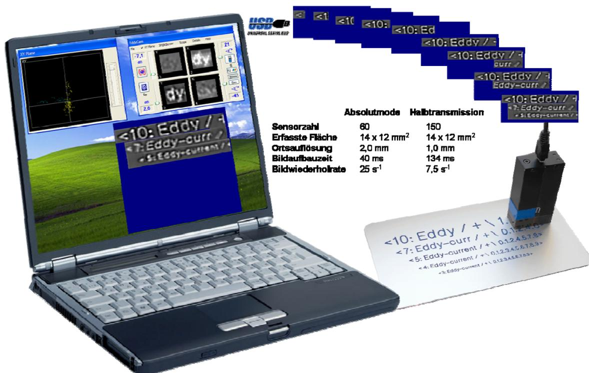
Bild 7: Das 60-Spulenarray am Notebook. Es deckt ohne mechanische Bewegung eine Fläche von 14 x 12 mm ab und findet Platz in einem Gehäuse BxTxH = 40 x 20 x 80 mm.
