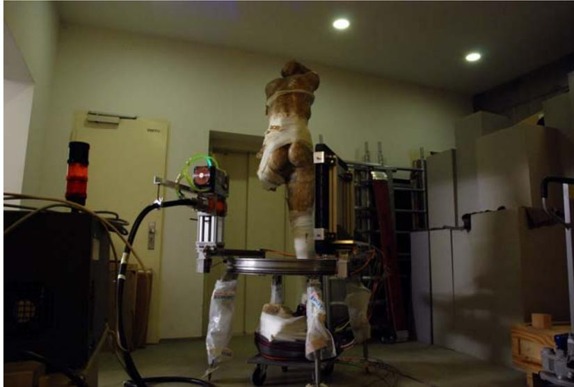
Abb. 1: Tomographie an der „Großen Nacht“ im Georg-Kolbe-Museum, Berlin. Die „Große Nacht“ (Gips, 1930) ist mit ihrer Größe von 2,12m und aufgrund des durch korrodierende Metallarmierung verursachten Schadensbildes nur sehr aufwendig transportfähig.
