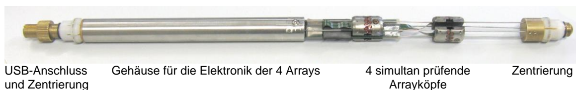
Bild 4: Niederfrequentes Sensorarray für die Rohrenprüfung mit eintauchfähigen Köpfen.
