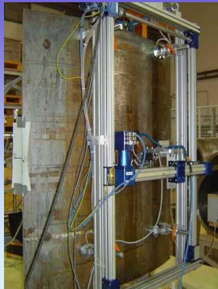
plattierte Druckbehältertestwand, Messaufbau
