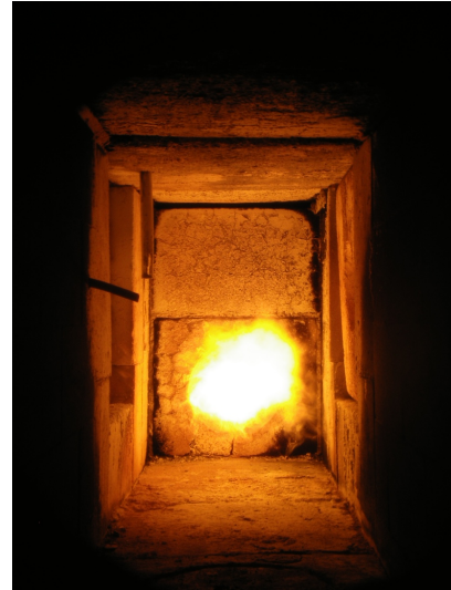
Abb. 2: Links: An den Kleinbrandofen eingesetzter Seitenprobekörper mit angeschlossenem Messsystem. Rechts: Blick in den Brandraum während eines Brandversuchs. Der Probekörper befindet sich in der Aussparung links.
