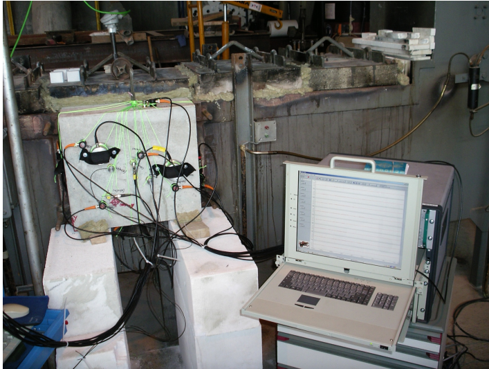
Abb. 2: Links: An den Kleinbrandofen eingesetzter Seitenprobekörper mit angeschlossenem Messsystem. Rechts: Blick in den Brandraum während eines Brandversuchs. Der Probekörper befindet sich in der Aussparung links.
