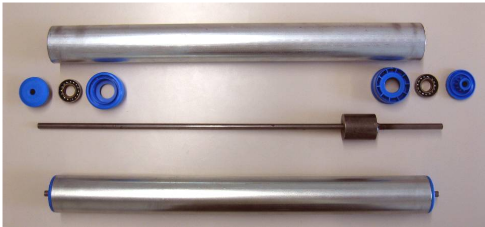
Abbildung 1: Tragrollenkomponenten; einzeln und im zusammengebauten Zustand für die Verwendung in einem Bauteilprüfstand
