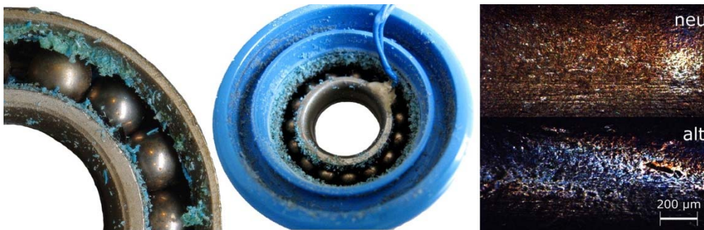
Abbildung 7: Visuelle Prüfung des belasteten Lagers
