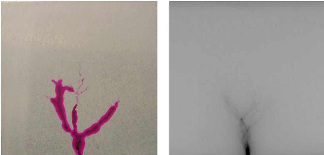
**Abbildung 3:** Spannungskorrosionsriss in Austenit-Testkörper – Farbeindringprüfung (links) und Durchstrahlungsprüfung (rechts)
