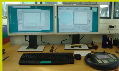
Saphir<sup>plus</sup> Ultraschallprüfsystem mit zwei parallel arbeitenden Bewertungsplatinen (Zyklen) für Parallelbetrieb in Echtzeit
