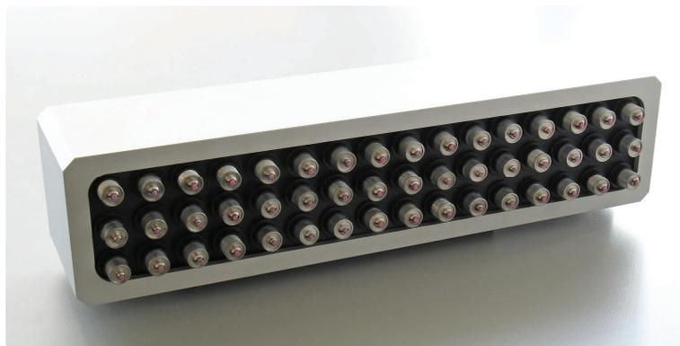
**Bild 3.** Ultraschall-Prüfkopfarray mit 48 Prüfköpfen in 16 Gruppen
