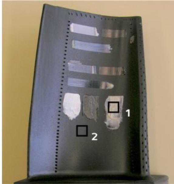
Abbildung 2: Mit Fotolack und verschiedenen Industriefetten beschichtete Turbinenschaufel. Von links oben nach rechts unten: Molykote (150 µm dick), Ceplattyn 300 (150 µm dick), Hochgeschwindigkeitsfett (150 µm dick), Molykote (50 µm dick), Ceplattyn 300 (50 µm dick), Hochgeschwindigkeitsfett (50 µm dick), Molykote (grob aufgetragen), Ceplattyn 300 (grob aufgetragen), Hochgeschwindigkeitsfett (grob aufgetragen)
