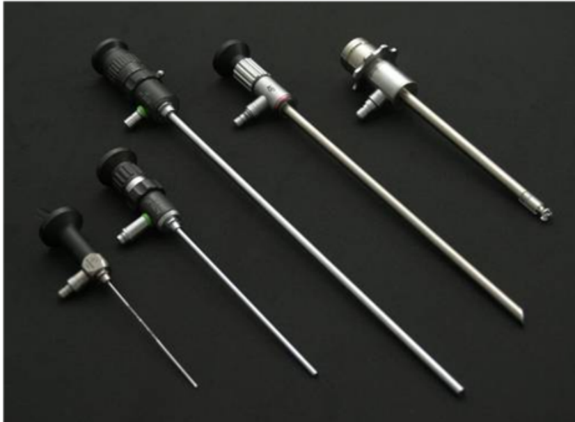
Abb. 1: Standard-Endoskop (auch Boreskop genannt) mit verschiedenen Durchmessern und typische industrielle Bohrungen.
