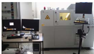
Abb. 1 : Röntgencomputertomograph der Hochschule Aalen (rechts) mit Rekonstruktionseinheit (links)
