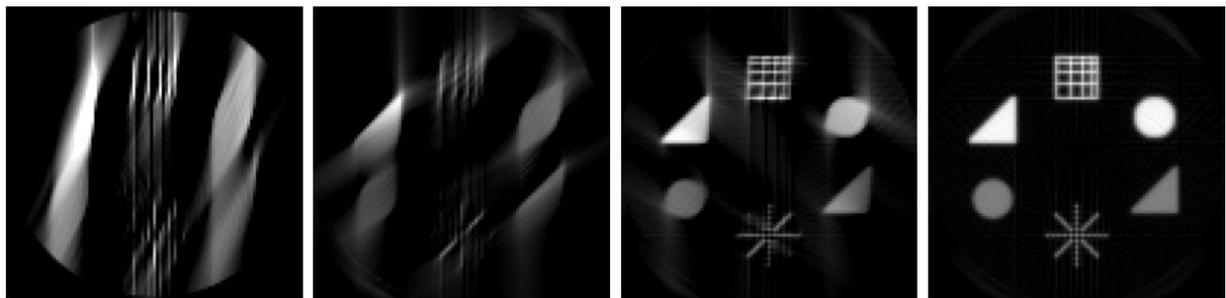
**Abb. 2:** Vergleich von Limited-View-Rekonstruktionen mit DIRECTT (oben) und gefilterter Rückprojektion (unten) mit skizzierten Projektionssektoren (Parallelstrahlgeometrie)
