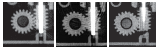
Prüfung der Getriebebeschmierung (i.O., n.i.O., n.i.O.)
