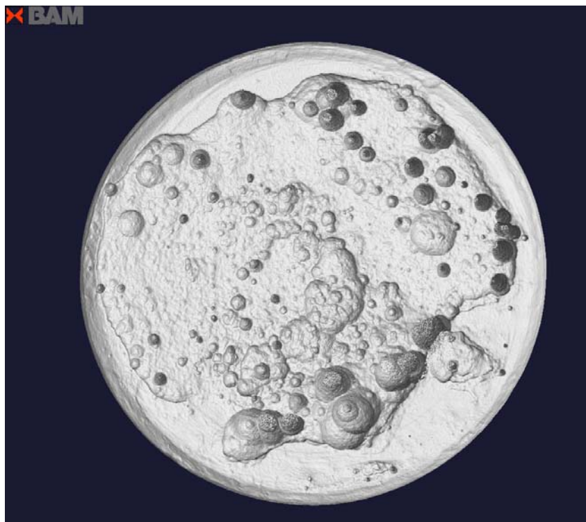
Abb. 5 Isosurface der korrodierten Anodenunterseite
