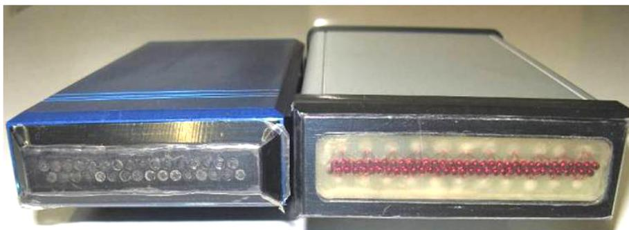
Bild 5: Links: Sensorzeile 32, 1,5-mm-Ferritkerne, Halbtransmission, Spulenabstand 3 mm, Gesamtpurbreite 45 mm, Sensorabstand ca. 1,5 mm. Rechts: Sensorzeile 64, 1,05-mm-Ferritkerne, Halbtransmission, Spulenabstand 2 mm, Gesamtpurbreite 61 mm, Sensorabstand ca. 1 mm
