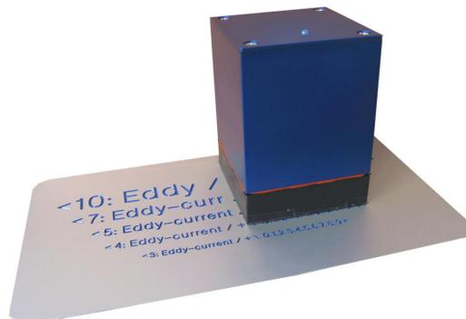
Bild 15: Das 2D-Array liefert ein komplettes Wirbelstrombild in 0,64 Sekunden
