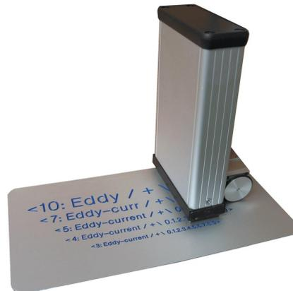
Bild 6: Links: Aluminiumblech mit Gravuren als Testfehler. Die erste Zahl der Zeile gibt die Schriftgröße in Millimeter an. Rechts: Zeilensensor 64 mit Wegaufnehmer über dem Testkörper
