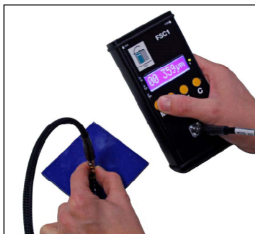
Abbildung 6: Mikrowellen-Schichtdickenmessgerät FSC-1 der Firma FIT-M [6]
