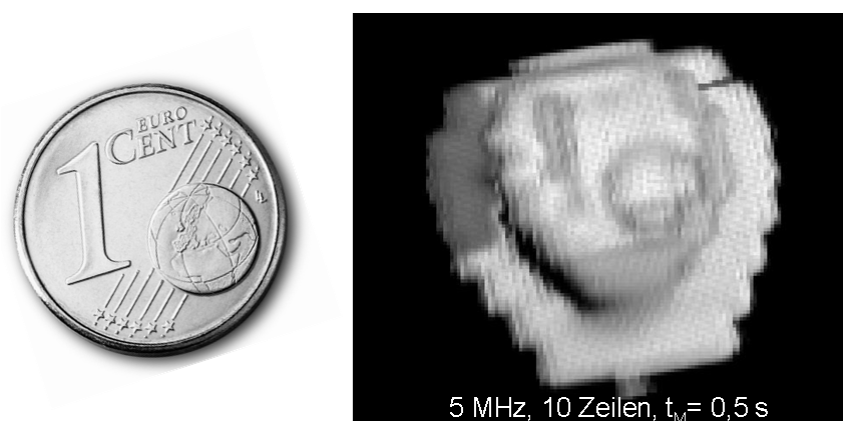
Bild 7: 3D Visualisierung der Ultraschallmessung einer 1ct Münze
