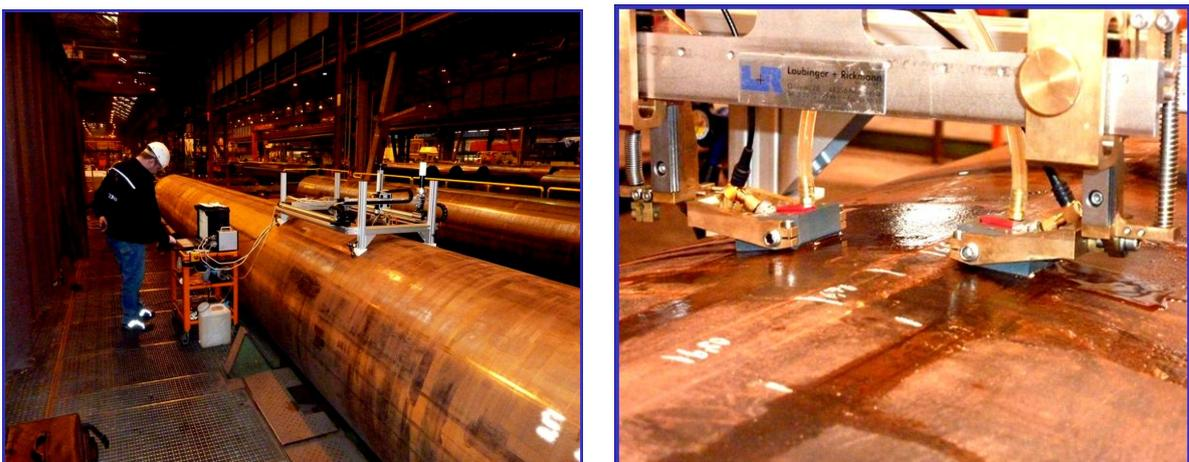
**Abb. 7** Halb-automatische SAFT-Prüfung von Schweißnähten an Großrohren.
