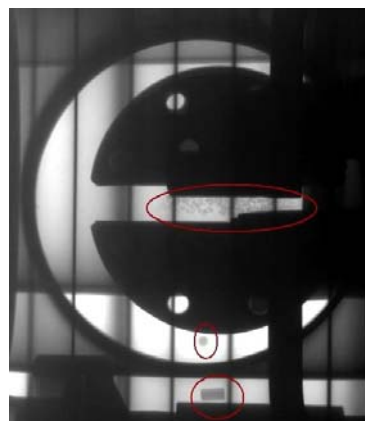
Bild 12: Radioskopie der Dioden-Anlage vom original getreuen Nachbau mit Ablagerungen und Fremdkörpern (Markierungen)
