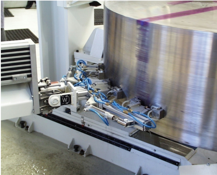
Fig. 2.3 Konventionelle Ultraschallprüfung, Prüfsystem mit 6 Einzelköpfen an einer Turbinenscheibe
